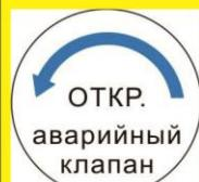
Если при отключении питания (или по другим причинам) платформа перестает опускаться при помощи обоих пультов управления, используйте аварийный клапан. Поверните клапан против часовой стрелки, и платформа медленно опустится. При полном опускании закройте клапан.
