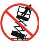
Будьте особенно внимательны при движении вышки с опущенной платформой по неровной, нестабильной или скользкой поверхности - двигайтесь на низкой скорости.
