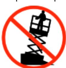
Запрещается перегрузка оборудования при неподходящих условиях эксплуатации. Не поднимайте платформу, если машина не находится на твердой ровной поверхности.
